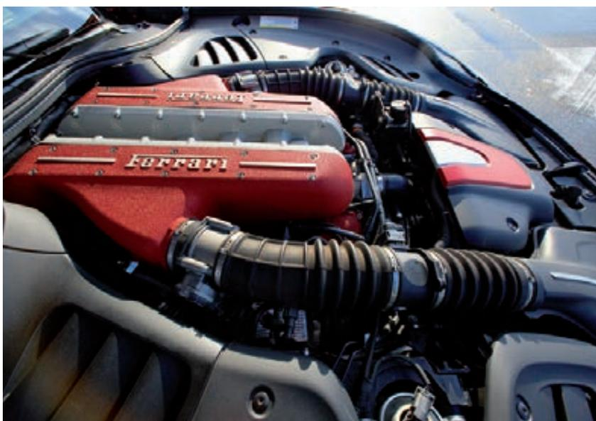
Augenweide: Der Zwölfzylinder, der aus seinen 6,2 Litern 660 PS und 683 Nm holt. Er ermöglicht den 100-km/h-Sprint unter vier Sekunden und eine Spitze von 335 km/h. Auch das Interieur, mit einzeln umklappbaren Rücksitzen, lässt keine Wünsche offen.
